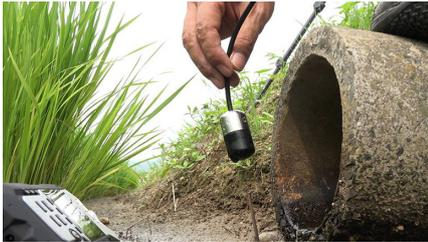
図 12 水田の水口から集音する水中用マイク (撮影：櫻井宏哉)
