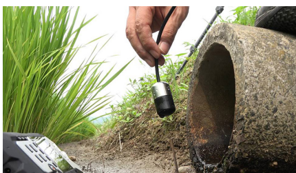
図 14 水田の水口から集音する水中用 マイク（撮影：櫻井宏哉）
