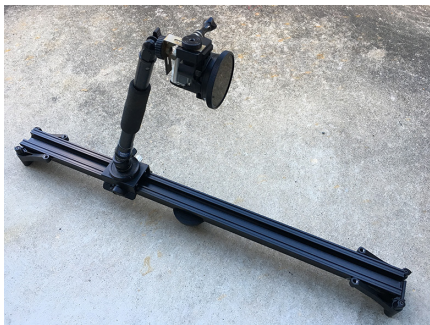
図8 スライダーの雲台に取り付けた一脚のローポジションの固定位置 (撮影：櫻井宏哉)
