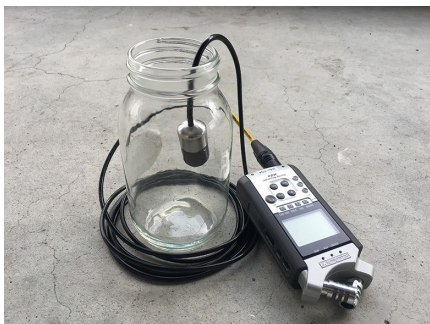
図 13 水中用マイク、IC レコーダー、 瓶（撮影：櫻井宏哉）
