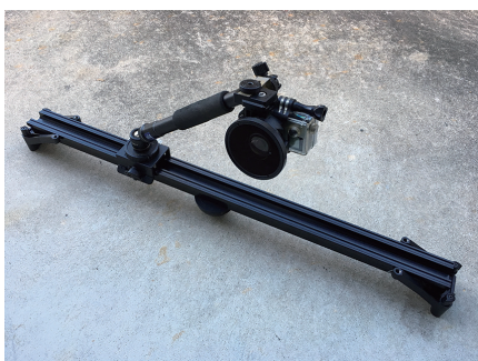
図10 スライダーの雲台に取り付けた一脚の側面撮影の固定位置 (撮影：櫻井宏哉)
