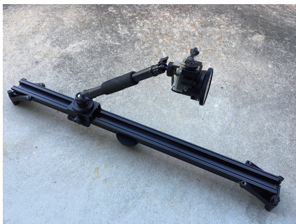
図7 スライダーの雲台に取り付けた一脚のハイポジションの固定位置 (撮影：櫻井宏哉)
