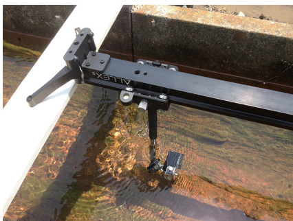
図6 移動撮影装置はスライダーと木材の支持体、水平に設置するためのアジャスターと水準器で構成（撮影：櫻井宏哉）
